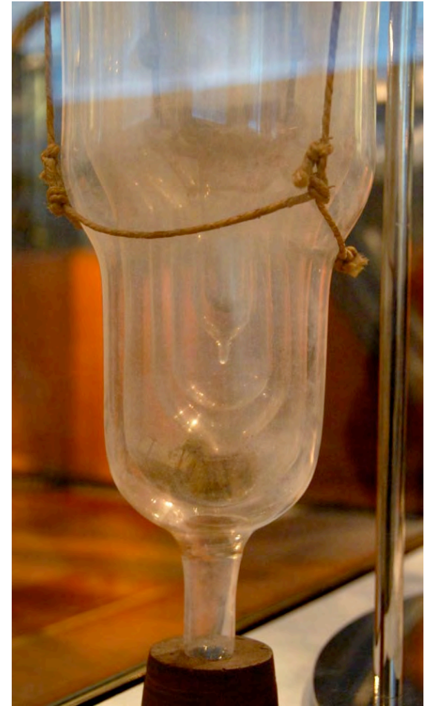
史上初めて液体ヘリウムが溜まったガラス容器 (1番内側の1.5 cm径の部分)
