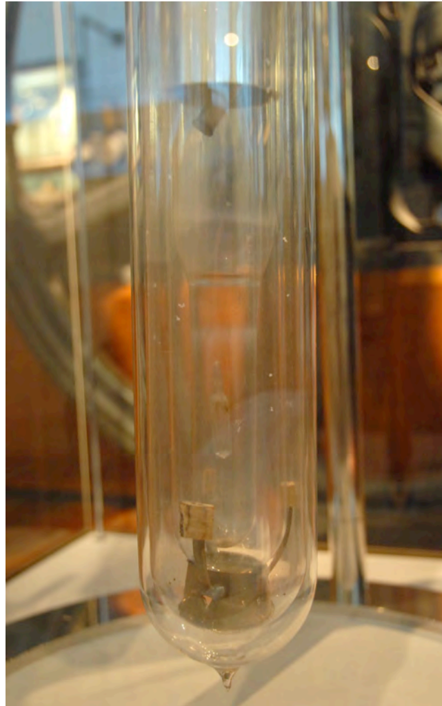
史上初めて液体ヘリウムが溜まったガラス容器 (1番内側の1.5 cm径の部分)
