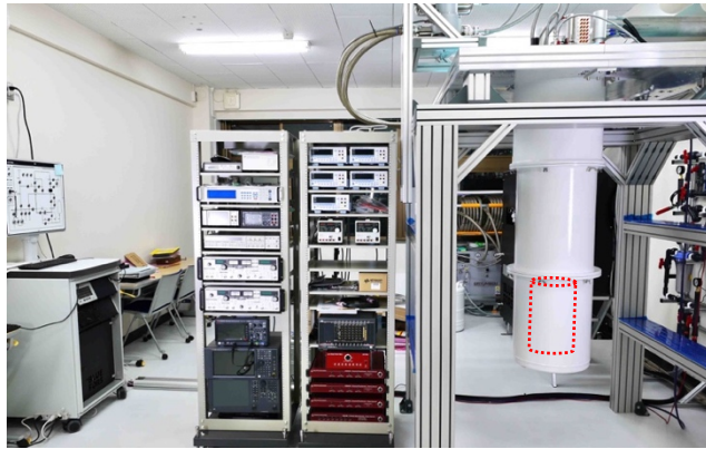
図1 希釈冷凍機とマイクロ波エレクトロニクスの全景。右側白い円筒形真空槽内の下部（点線部）が実験空間。
